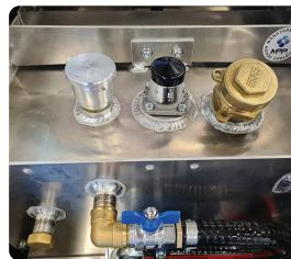
2 Zoll Füllstandsanzeige, 2 Zoll Tankdeckel, 1 Zoll Überdruck- / Unterdruckventil.
