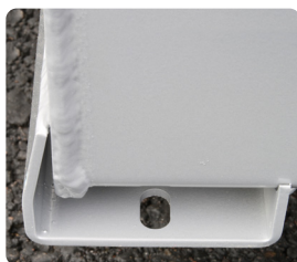
Schutzkufen mit Montagehalterung für die Ladefläche
